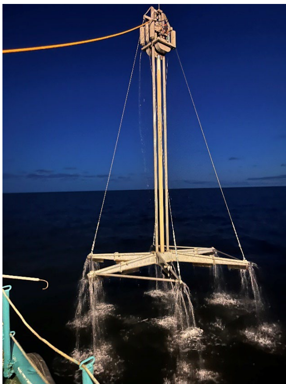
Pav. 3. Vibro gręžimo prietaisas
